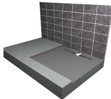
Erweitern Sie die Ausschachtung, um Platz für Siphon und Abwasserrohr zu schaffen. Der Siphon ist um 360° drehbar, was zur Flexibilität der gewünschten Positionierung beiträgt. Stellen Sie sicher, dass der Siphon von unten von Beton gestützt ist. Falls die geschaffene Öffnung zu tief ist, bringen Sie eine zusätzliche Zementunterstützung an.
